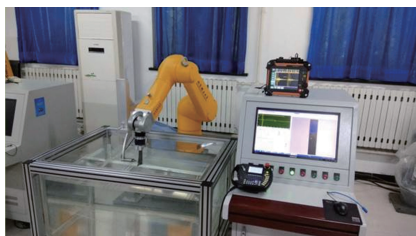
图3 机械手无损检测系统
